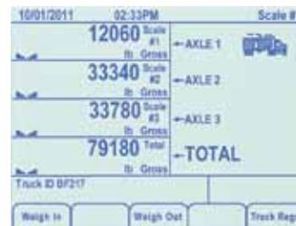
Una pantalla con capacidad de 32 canales les permite ver el peso en una báscula individual y una combinación de básculas totalizadas.
